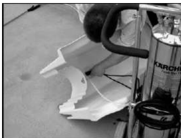
Contrôler le raccord de flexible et le raccord du commutateur.
