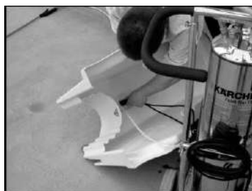
Controllare il collegamento del tubo flessibile e dell'interruttore.
